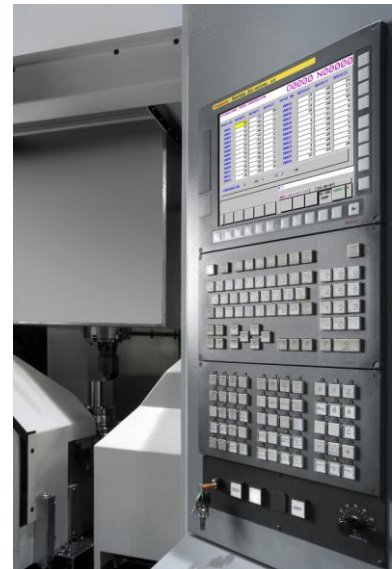
DIE FUNKTION „3D ERROR COMPENSATION“ FÜR DIE FANUC CNC-STEUERUNGEN DER SERIEN 30I UND 31I-A5 KORRIGIERT GEOMETRISCHE MASCHINENFEHLER.
