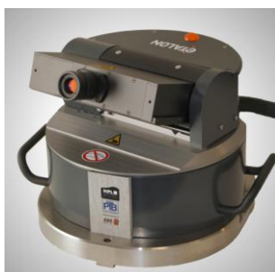
DER LASERTRACER IST IM ZUSAMMENHANG MIT EINEM REFLEKTOR DAS EINZIG NOTWENDIGE MESSMITTEL.
